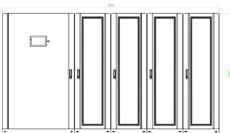
(ж) Внешний вид шкафа на 32 слота (вид спереди)
