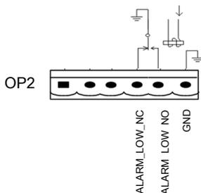
Рисунок 3.21. Схема интерфейса выходного релейного контакта общей тревоги
