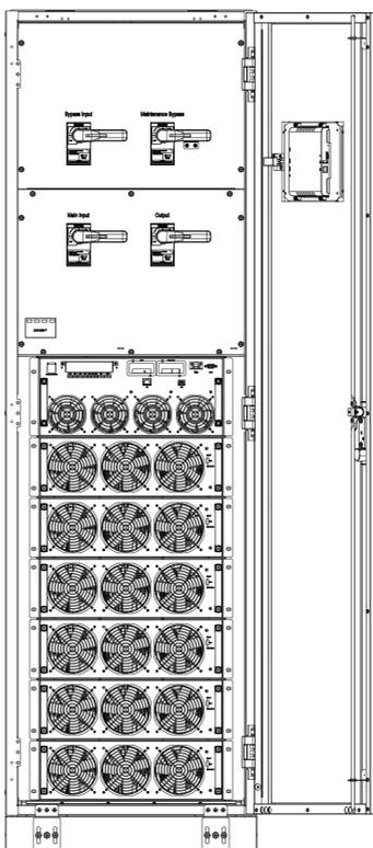
(б) Шкаф ИБП на 6 слотов, открытые дверцы, вид спереди
