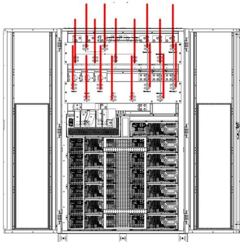
Рисунок 3.11. Верхний ввод силовых кабелей в шкафах ИБП с верхним и нижним вводом
