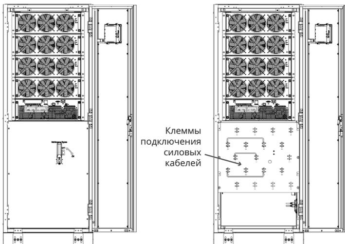
(б) Шкаф ИБП на 4 слота, открытые дверцы, нижний ввод, вид спереди
