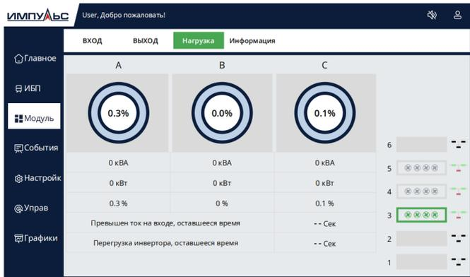
Рисунок 4.14. Меню силового модуля, страница параметров нагрузки
