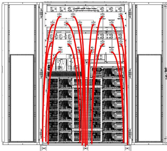
Рисунок 3.10. Нижний ввод силовых кабелей в шкафах ИБП с верхним и нижним вводом
