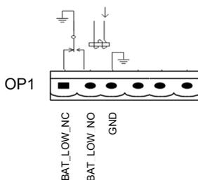
Рисунок 3.20. Схема интерфейса выходного релейного контакта предупреждения о низком напряжении АКБ
