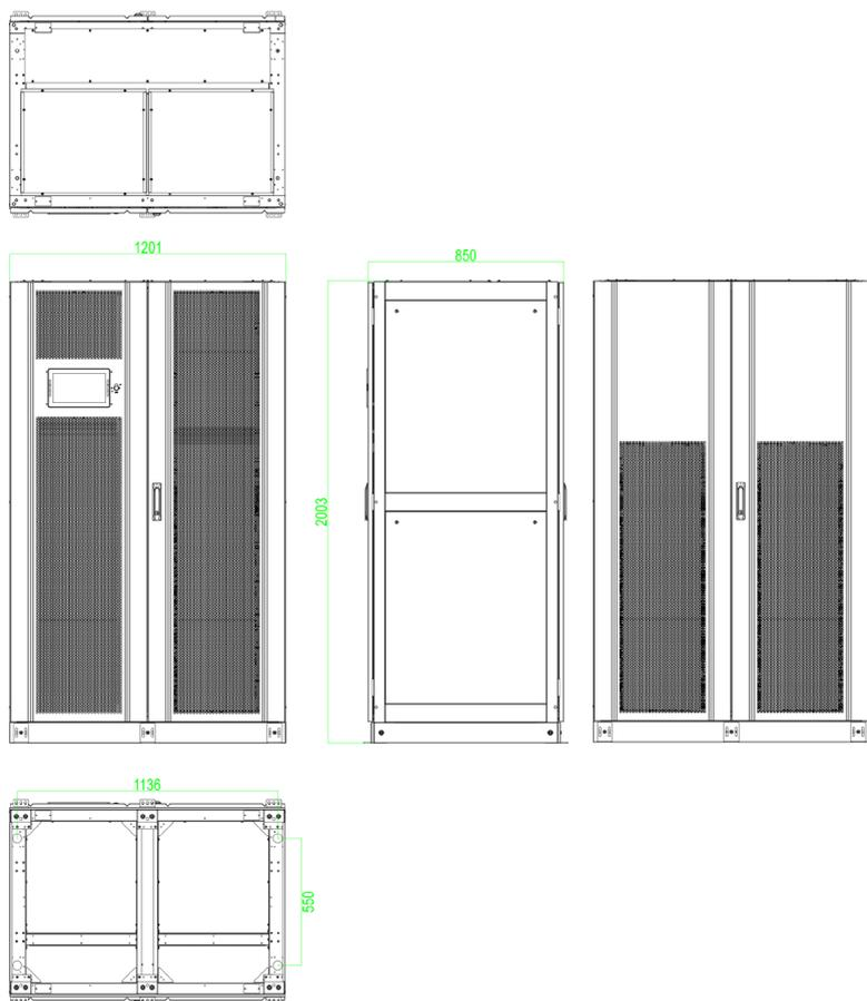
(а) Шкаф ИБП на 13 слотов, встроенные выключатели, закрытые двери
