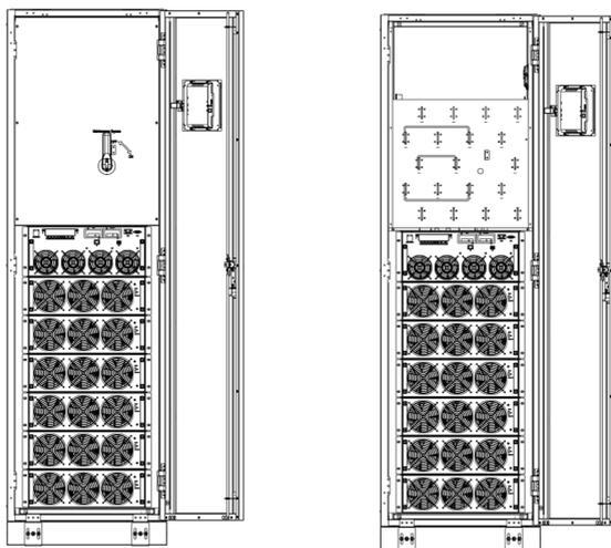
(в) Шкаф ИБП на 6 слотов, открытые дверцы, верхний ввод, вид спереди
