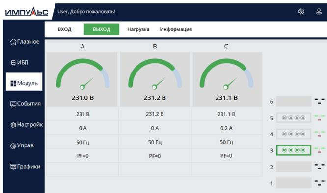
Рисунок 4.13. Меню силового модуля, страница выходных параметров
