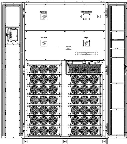
(б) Шкаф ИБП на 13 слотов, встроенные выключатели, открытые дверцы, вид спереди
