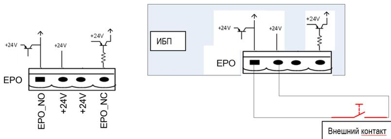
Рисунок 3.16. Схема входного порта для дистанционной подачи команды EPO
