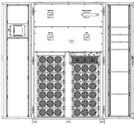
(б) Шкаф ИБП на 13 слотов, встроенные выключатели, открытые дверцы, вид спереди
