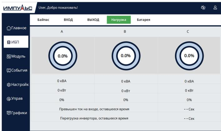
Рисунок 4.9. Меню шкафа ИБП, страница параметров нагрузки
