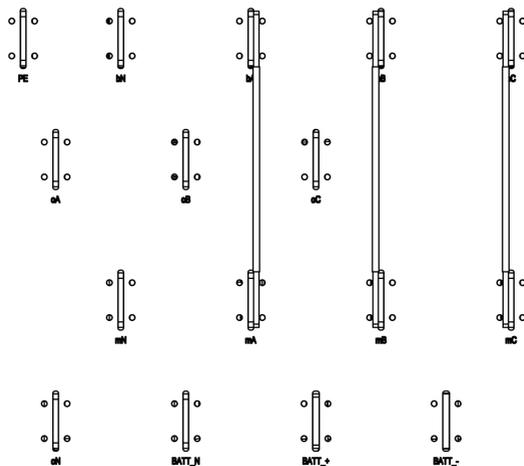
Рисунок 3.13. Расположение силовых клемм в шкафах ИБП с 8 слотами
