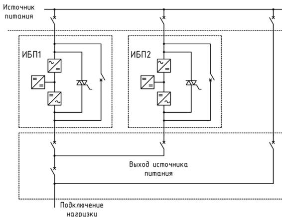
Рисунок 3.24. Схема параллельного подключения ИБП
