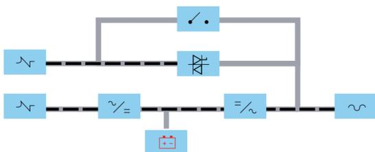
Рисунок 5.3. ИБП в нормальном режиме, АКБ не подключены
