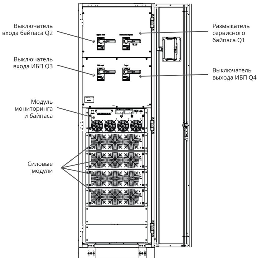
(б) Шкаф ИБП на 4 слота, открытые дверцы
