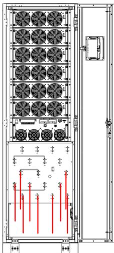
Рисунок 3.8. Нижний ввод силовых кабелей
