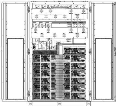
(в) Шкаф ИБП на 13 слотов, встроенные выключатели, открытые дверцы, вид сзади
