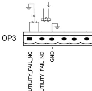
Рисунок 3.22. Схема интерфейса выходного релейного контакта предупреждения отказа сети
