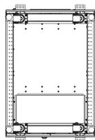
(а) Шкаф ИБП на 4 слота, закрытые дверцы
