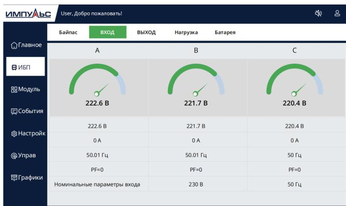
Рисунок 4.7. Меню шкафа ИБП, страница параметров входа ИБП (сеть)
