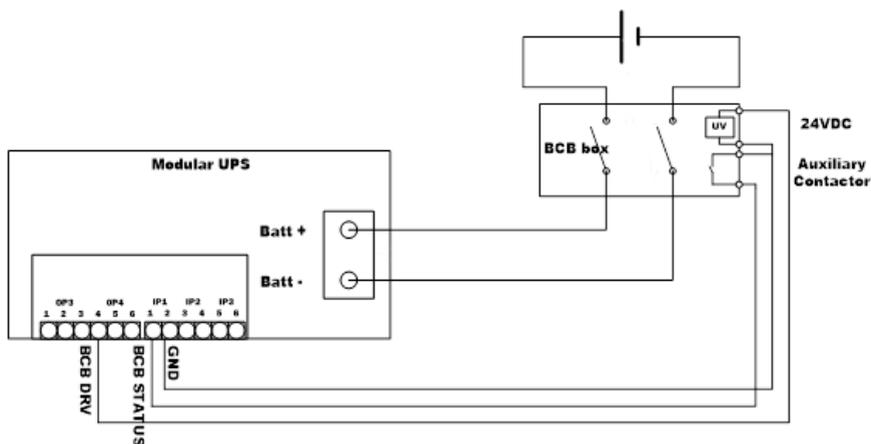
Рисунок 3.7. Схема подключения АКБ с использованием автоматического выключателя батарей с приводом отключения
