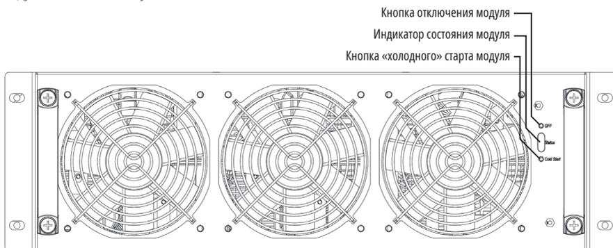
Рисунок 4.1. Фронтальная панель силового модуля
