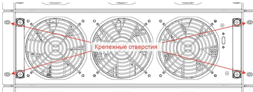
Рисунок 3.5. Расположение крепежных отверстий фиксации силового модуля
