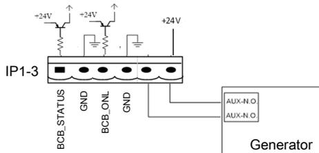
Рисунок 3.18. Схема входного порта для контроля работы от генератора
