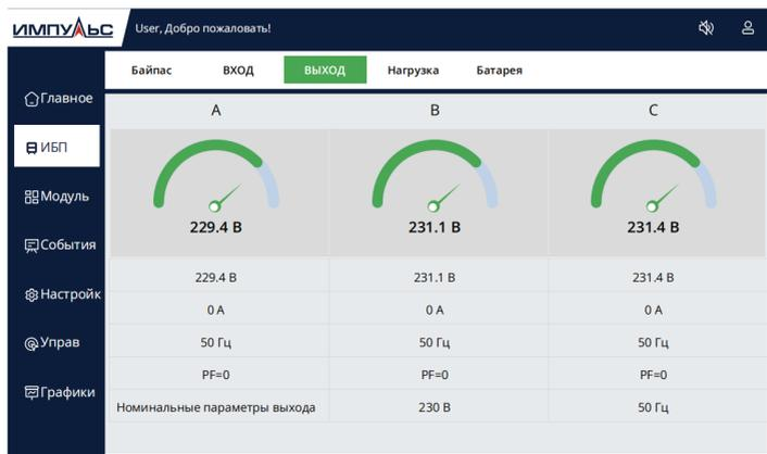
Рисунок 4.8. Меню шкафа ИБП, страница выходных параметров
