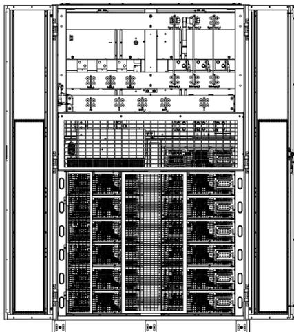
(в) Шкаф ИБП на 13 слотов, встроенные выключатели, открытые дверцы, вид сзади
