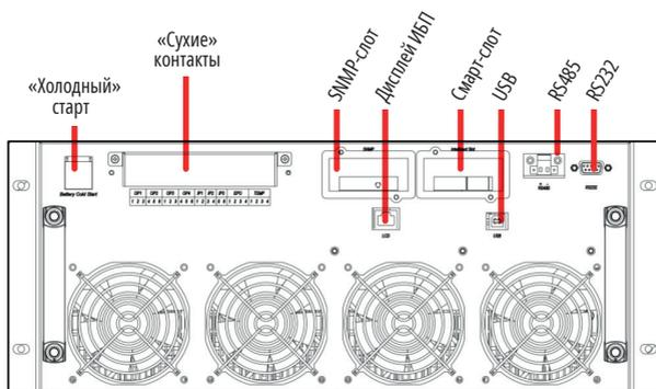
(б) для шкафов ИБП мощностью 300, 400 кВА
