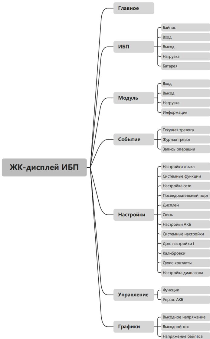
Рисунок 4.5. Схема структуры меню
