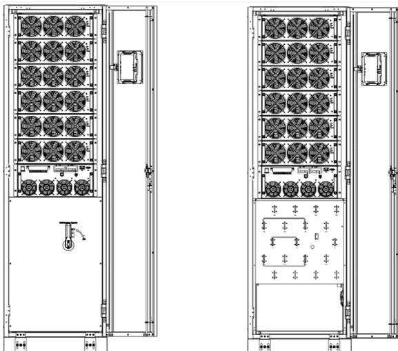
(б) Шкаф ИБП на 6 слотов, открытые дверцы, нижний ввод, вид спереди
