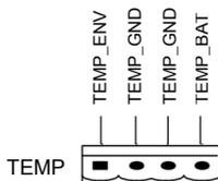
Рисунок 3.17. Порты TEMP 1-4 для определения температуры
