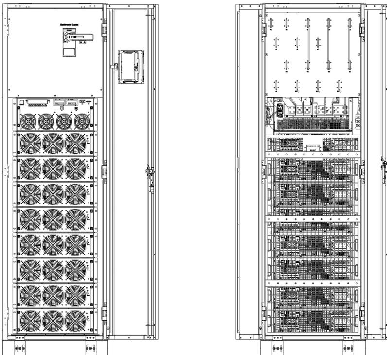
(б) Шкаф ИБП на 8 слотов, открытые дверцы, (вид спереди / сзади)
