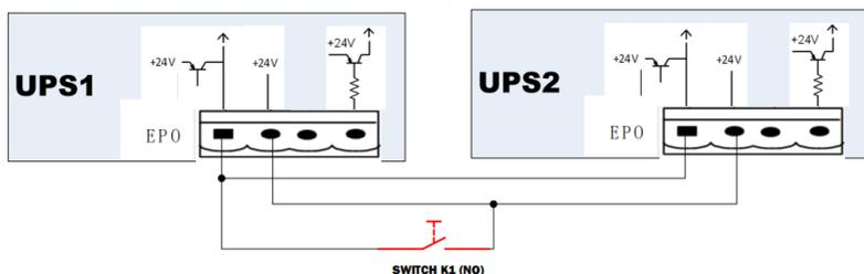
Рисунок 3.25. Подключение внешней кнопки для дистанционной подачи команды EPO в параллельной системе
