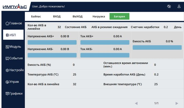
Рисунок 4.10. Разделы подменю ИБП: параметры АКБ
