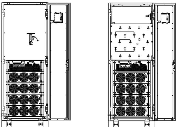
(в) Шкаф ИБП на 4 слота, открытые дверцы, верхний ввод, вид спереди
