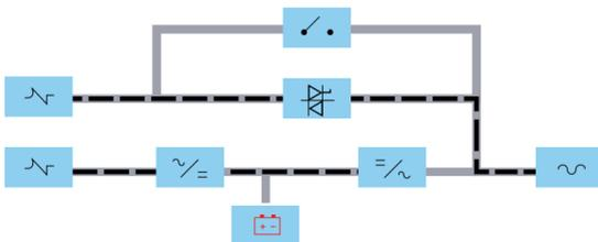
Рисунок 5.2. Запуск инвертора, выход ИБП запитан через байпас
