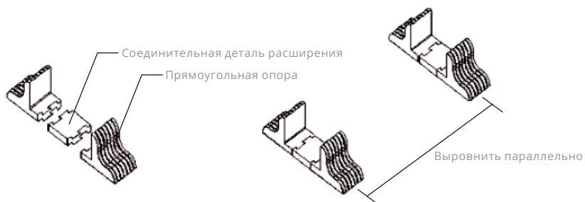
Рис. 3.2.3.2. Схема сборки опор
