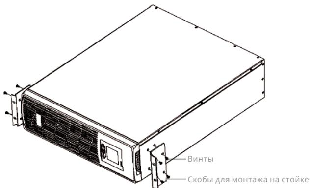
Рис. 3.2.4.3. Установка креплений для монтажа в стойку
