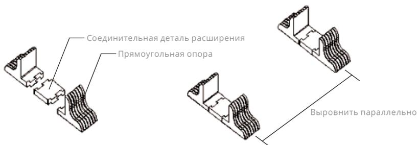
Рис. 3.2.4.2. Схема сборки опор
