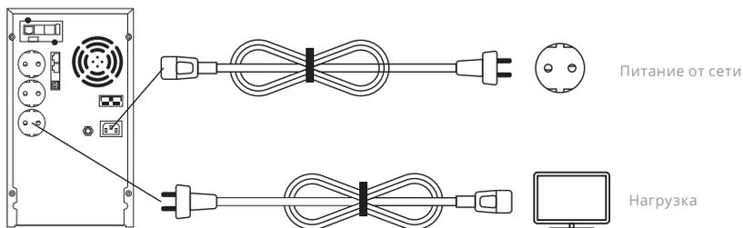
Рис. 3.2.2. Схема подсоединения входа/выхода напольного ИБП 3000 ВА\*
