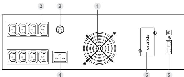
Рис. 2.3.2. Задняя панель ИБП в стойку (ЮНИОР ПРО RT) 2000 - 3000 ВА 3U
