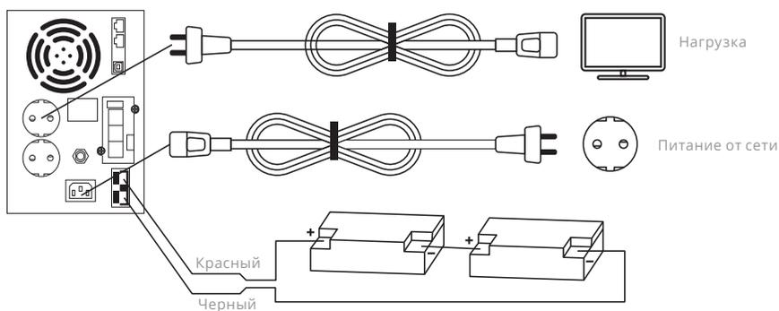
Рис. 3.2.3. Схема подсоединения входа/выхода напольного ИБП 24V пост. тока\*
