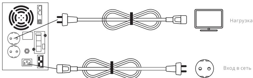
Рис. 3.2.2. Схема подсоединения входа/выхода напольного ИБП 1000 – 2000 ВА\*
