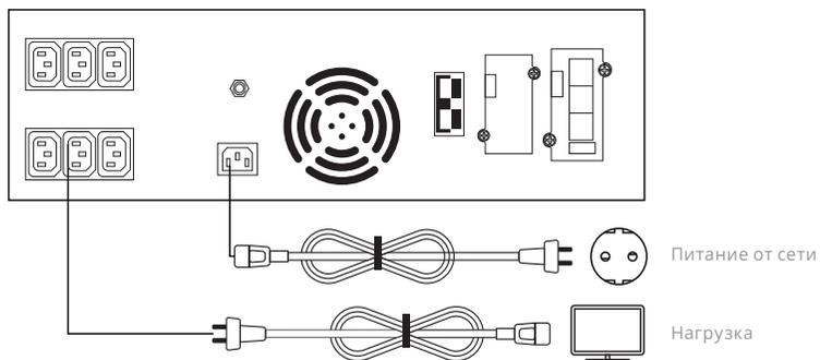
Рис. 3.2.4.1. Схема подсоединения входа/выхода ЮНИОР ПРО РТ 48V пост. тока
