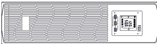
Рис. 2.2.2. Стандартная панель для ИБП в стойку
